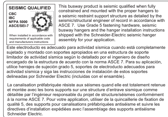
Figura 1: Etiqueta de conformidad con actividad sísmica
