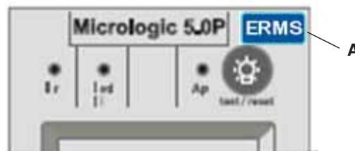
Figure 1 : Étiquette ERMS sur le déclencheur
