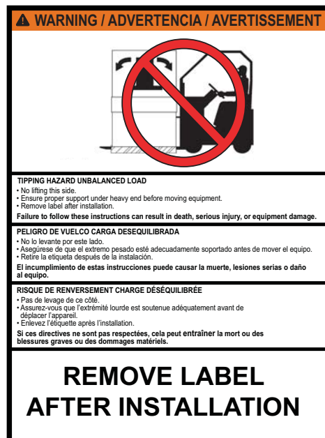
Figure 5 – Étiquette d'avertissement sur la face avant, panneaux de commutation à l'épreuve de la pluie
