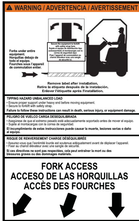
Figura 4 – Etiqueta de advertencia en la parte posterior – Tableros de distribución a prueba de lluvia
