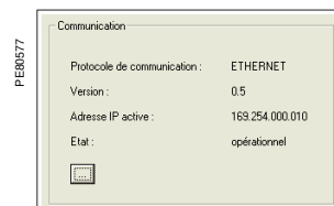
Détail de l'écran Diagnostic : ACE850 connectée correctement.
