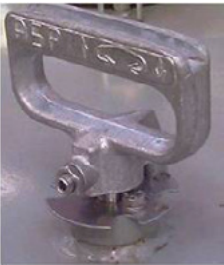
Pour les appareils à 2 tensions primaires, un second changeur de commutation est à disposition pour sélectionner la position HT1 ou HT2 désirée, en fonction des instructions données par la plaquette à côté du changeur
