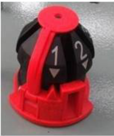
Ajuster le changeur de prises sur la position désirée en fonction des instructions données par la plaque signalétique du transformateur.
