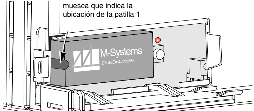
Figura 7: Ubicación de la patilla 1 en el chip de memoria existente
