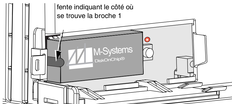
Figure 12 : Emplacement de la broche 1 sur la puce mémoire existante
