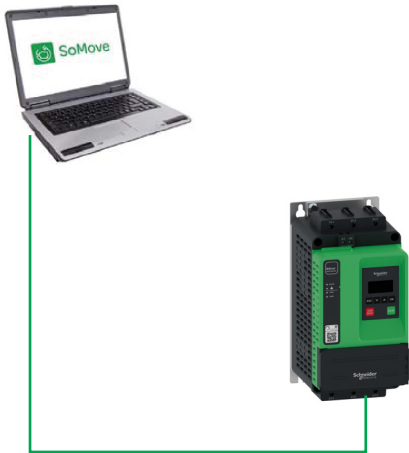
Atualização de firmware via serial Modbus usando SoMove
