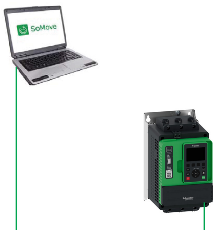
Atualização de firmware via Modbus TCP/ Ethernet/IP ou Modbus serial usando SoMove
