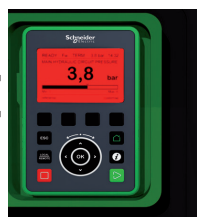
Falha detectada: A luz de fundo vermelha da tela é ativada automaticamente
