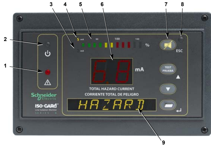
Figure 9 : Afficheur du panneau avant—Condition d'alarme
