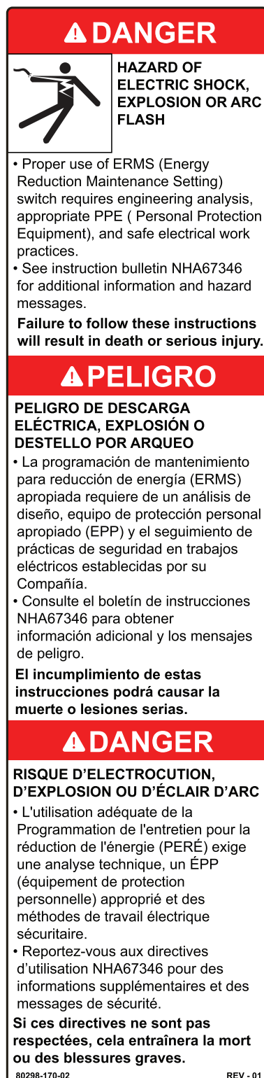
Figura 25 – Etiqueta para la opción de conmutador ERMS remoto
